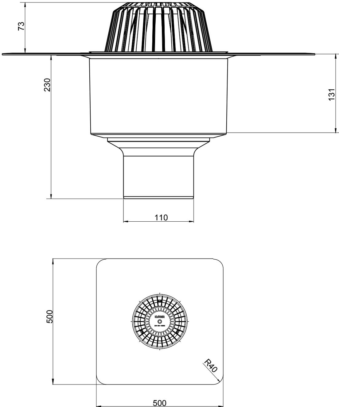
KF 7201-100 Flavent® pro Dachablauf DN 100 mit Bitumen-Manschette
