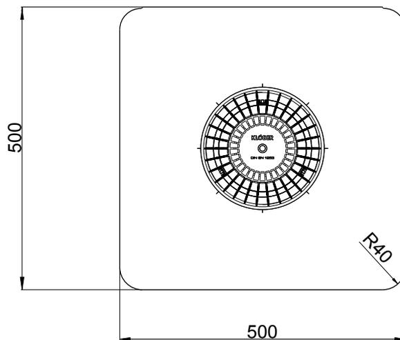
KF 7201-70 Flavent® pro Dachablauf DN 70 mit Bitumen-Manschette
