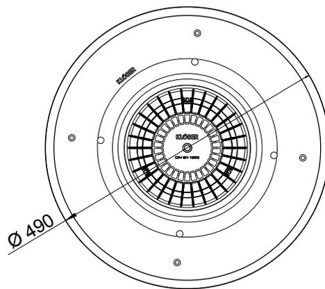
KF 7200-70 Flavent® pro Dachablauf DN 70 mit PPO-Flansch
