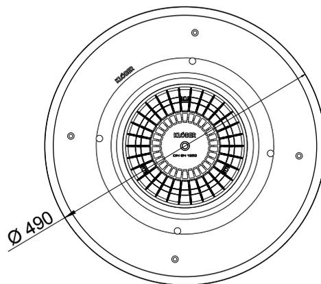
KF 7200-100 Flavent® pro Dachablauf DN 100 mit PPO-Flansch
