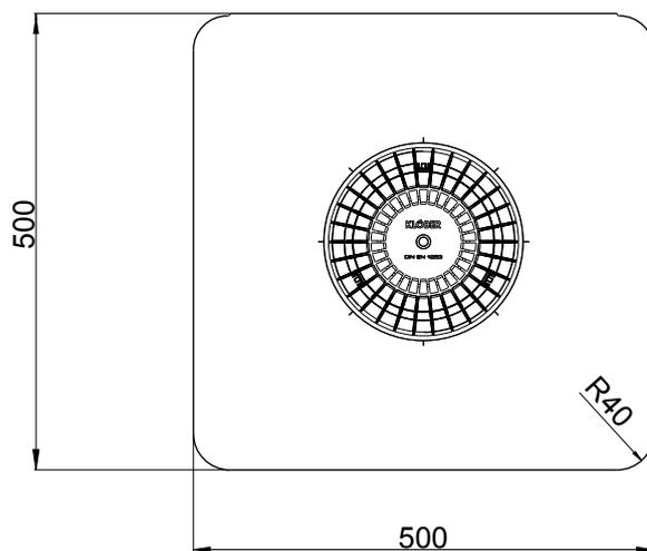
KF 7201-150 Flavent® pro Dachablauf DN 150 mit Bitumen-Manschette
