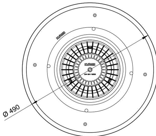
KF 7300 Flavent® pro Aufstockelement mit PPO-Flansch
