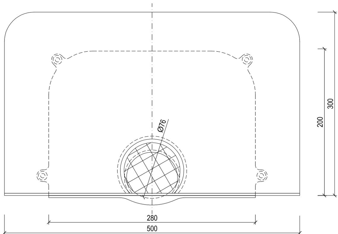
KF 6531-1 Flavent® Attika-/Balkonablauf DN 70 mit Bitumen-Manschette
