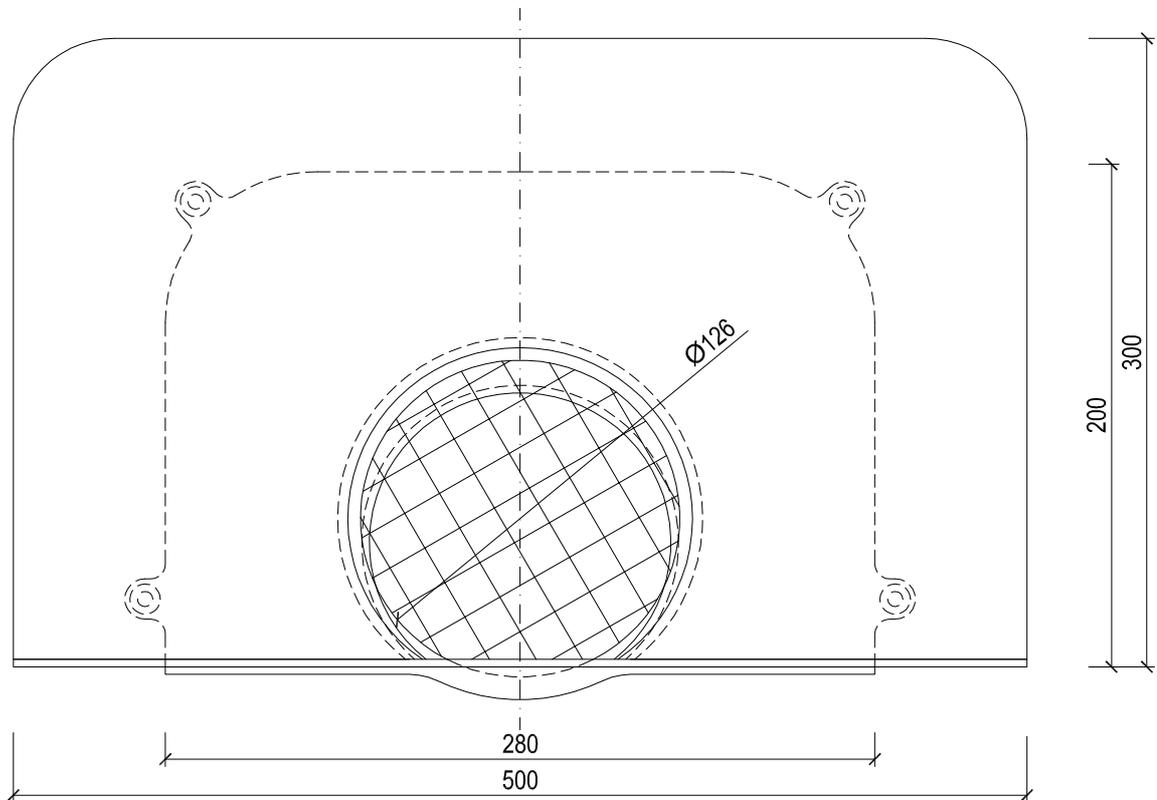
KF 6551-1 Flavent® Attika-/Balkonablauf DN 125 mit Bitumen-Manschette
