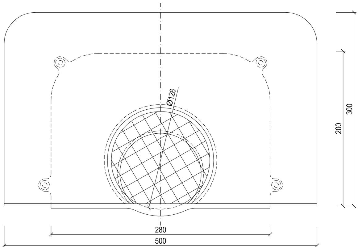
KF 6541-1 Flavent® Attika-/Balkonablauf DN 100 mit Bitumen-Manschette
