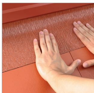
TOP-FLEX® pro ist ein universelles Anschlussband für Anschlüsse der Dachdeckung an aufgehende oder durchdringende Bauteile im geneigten Dach. Durch die metallische Oberfläche aus farblich beschichtetem und gekrepptem Aluminium, weist TOP-FLEX® pro eine Dehnfähigkeit in Abrollrichtung von bis zu 30% auf. Aufgrund der hohen Klebekraft des Butyls wird das Hochziehen durch starke Windeinflüsse wirkungsvoll verhindert.
